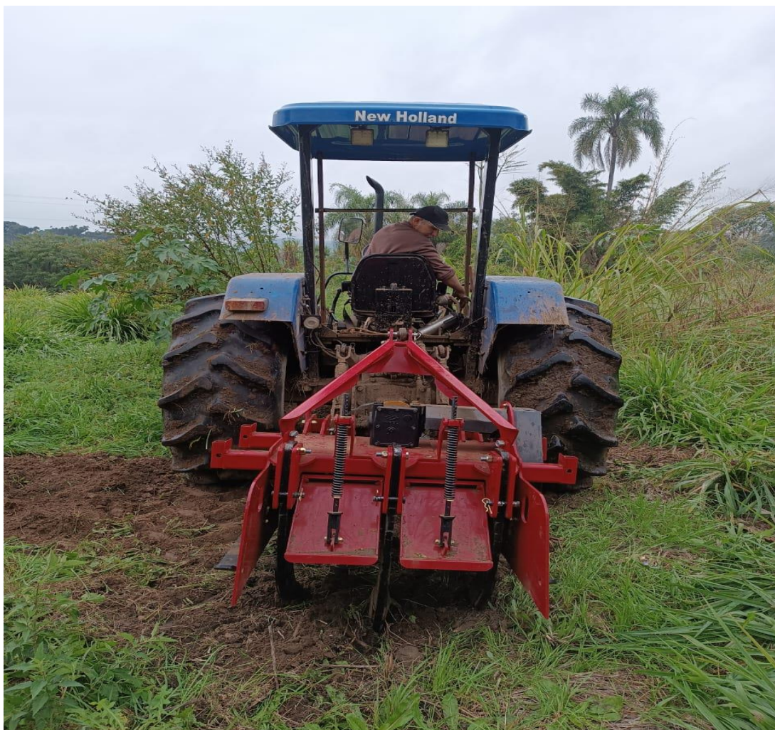
Figura 18 – Subsolador Rotativo Agroflorestal adquirido pelo agricultor
