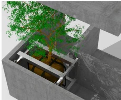
Figura 51: Gaiola de aço nos terraços | Bosco Verticale
