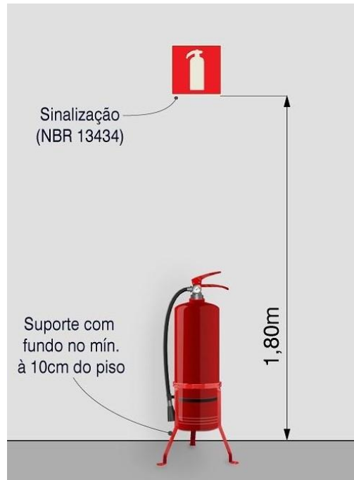
Figura 9 - Instalação no piso
