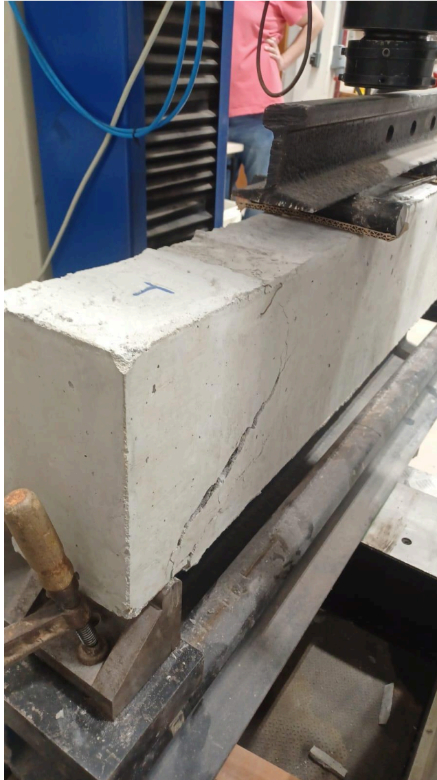
Figura 34 - Viga testemunho rompida
