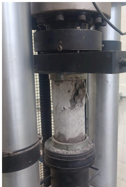
Figura 32 - Corpo de prova rompido
