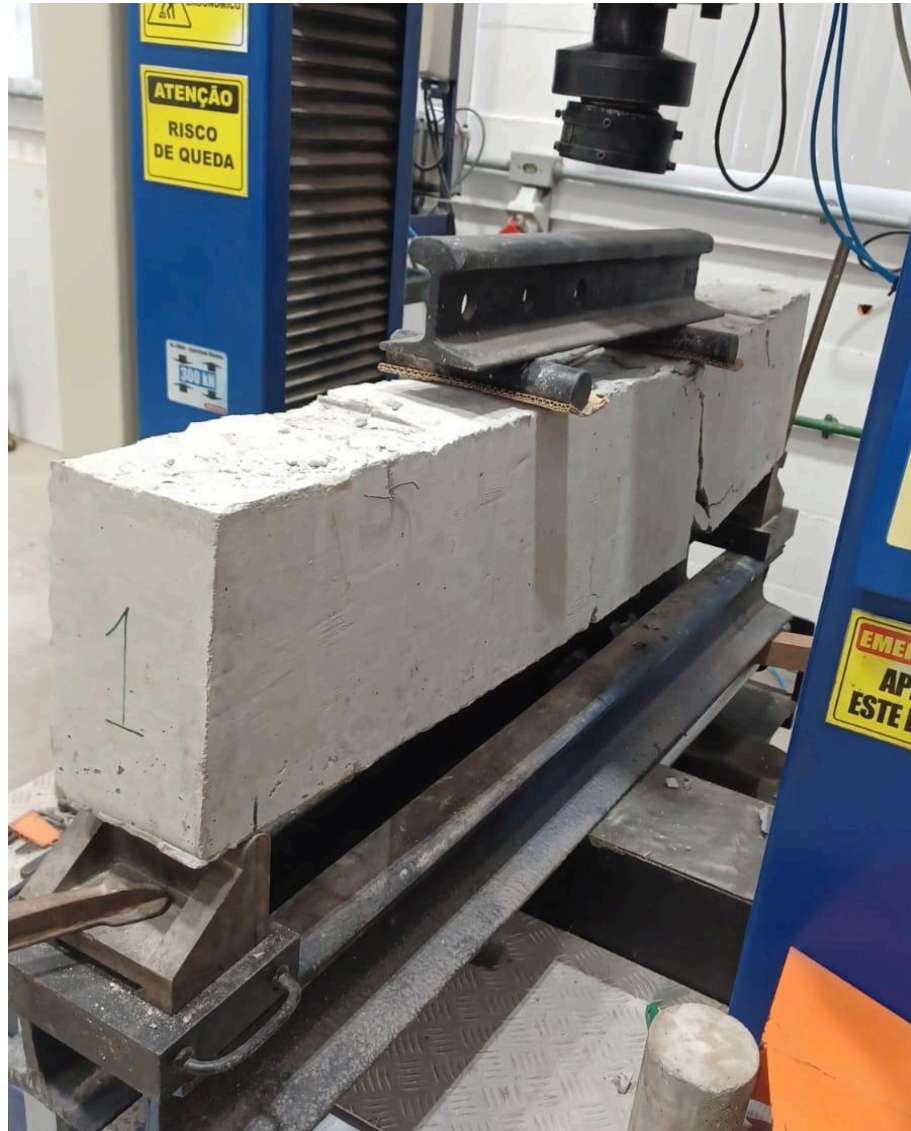
Figura 37 - Viga PRFV 1 rompida
