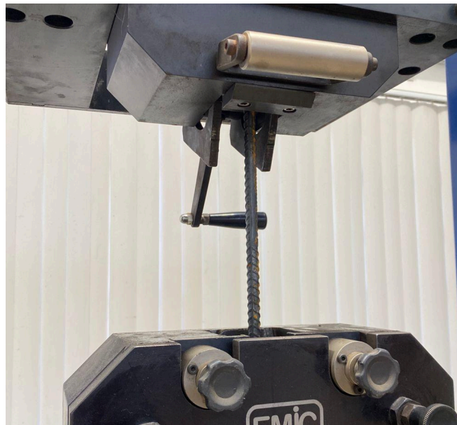
Figura 28 - Tração na barra de aço
