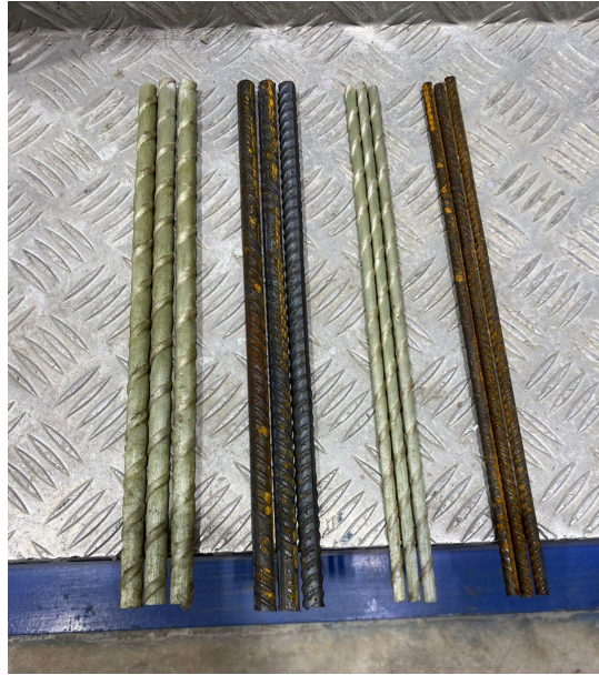
Figura 27 - Barras de aço e PRFV a serem tracionadas
