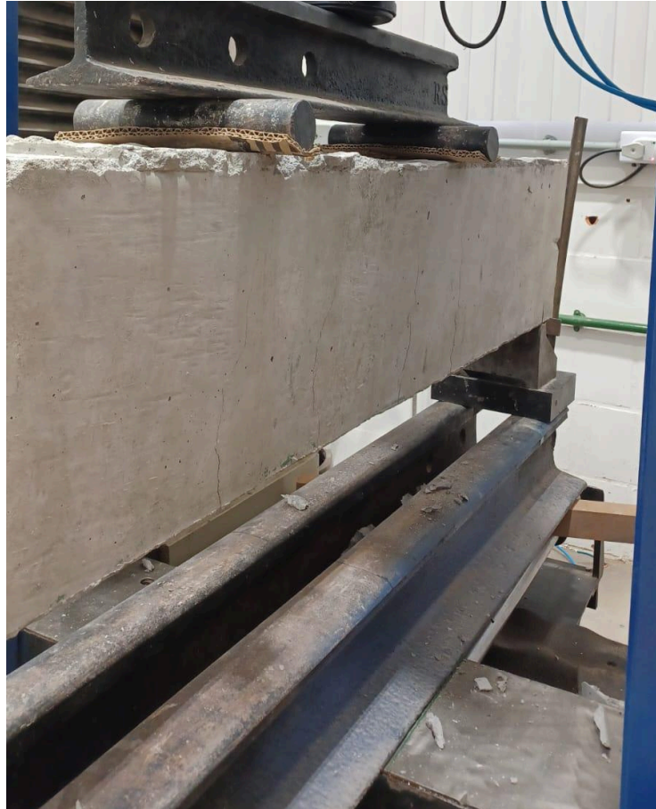
Figura 40 - Viga PRFV com fissuração
