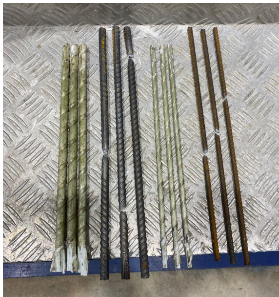
Figura 30 - Barras de aço e PRFV após o rompimento
