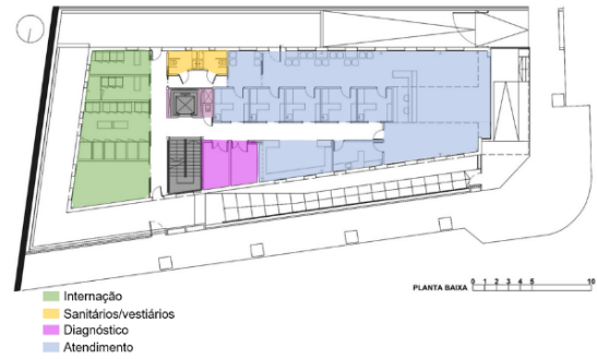
Figura 57- Planta baixa segundo pavimento
