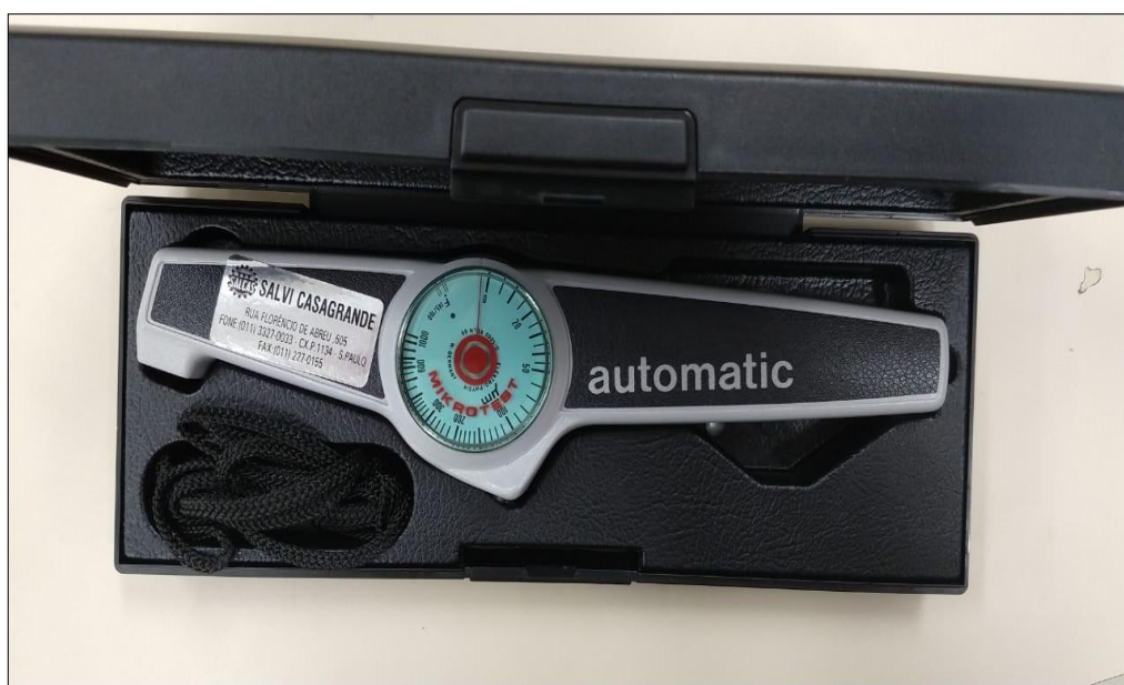
Figura 12 - Medidor de Espessura de Camada Galvânica
