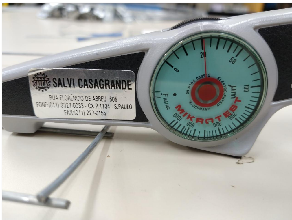
Figura 24 - Medição da camada galvânica fio 2,30mm leve retrefilado
