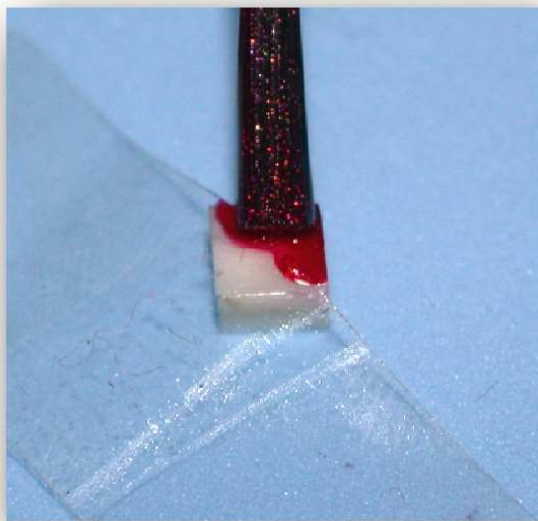
FIGURA 10- Proteção do fragmento
