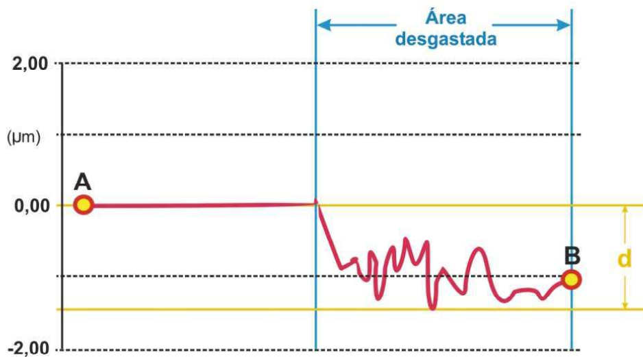
FIGURA 16- Ilustração esquemática mostrando o desgaste dos espécimes testados. (A) início da leitura feita pelo rugosímetro, (B) final da leitura feita pelo rugosímetro e (d) medição do desgaste
