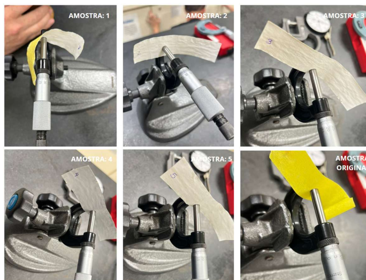
Figura 58 – Medida da espessura da película pintada
