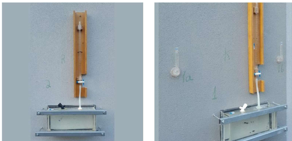
Figura 36 – Ensaio de Permeabilidade – Método da caixa
