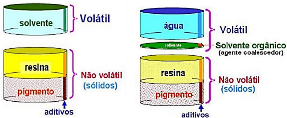
Figura 19 - Componentes básicos de tinta à base de solvente e água
