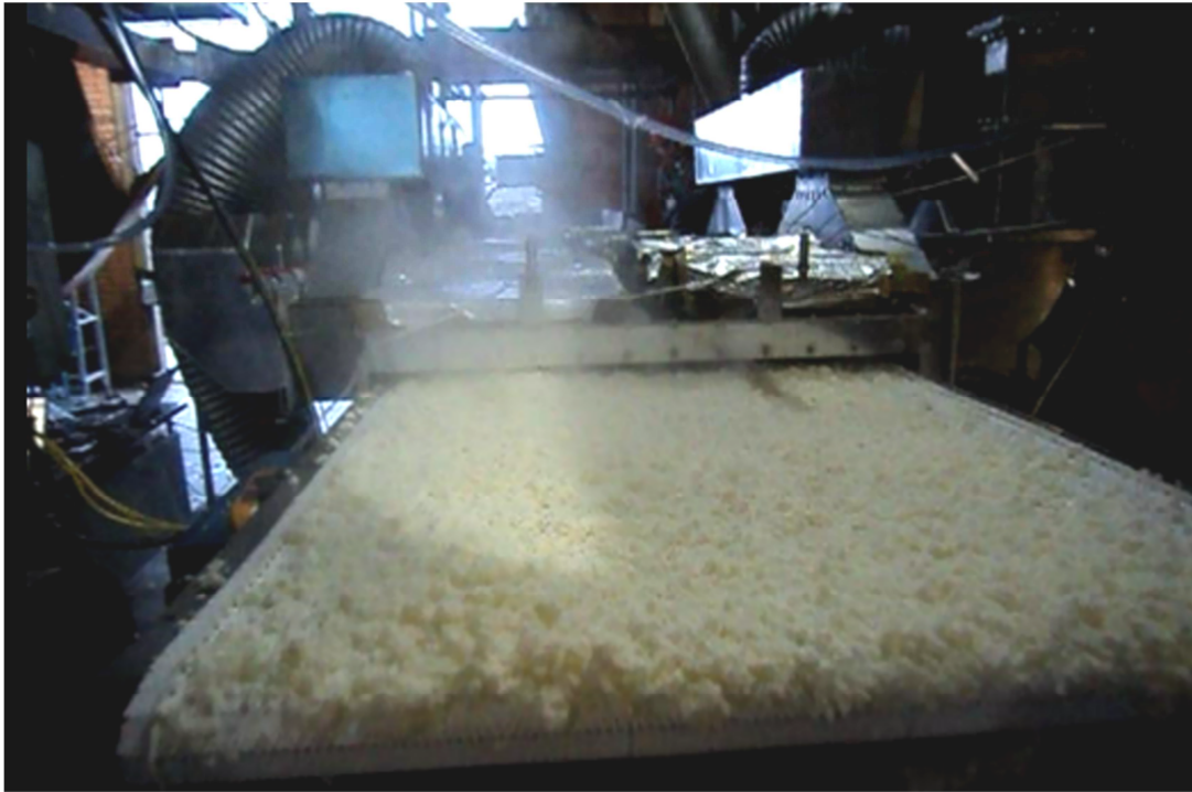
Figura 18 – Camada de borracha na saída do aplicador Fonte: Autor, 2012.
