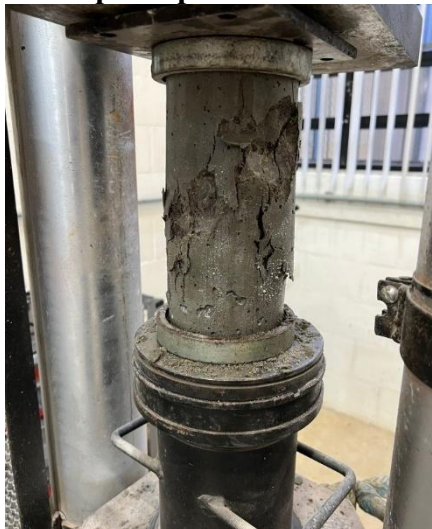
Figura 26 - Corpo de prova durante ensaio
