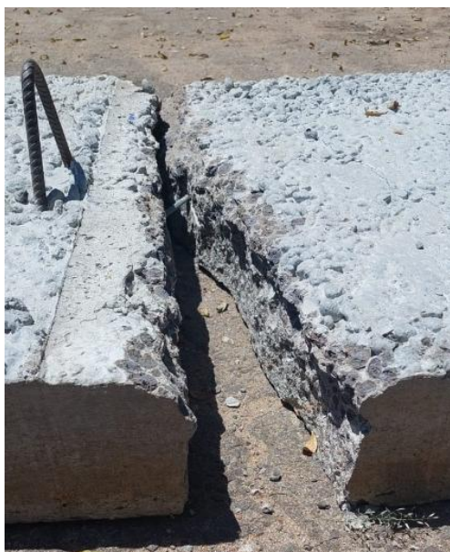
Figura 32 - Laje LCLE rompida
