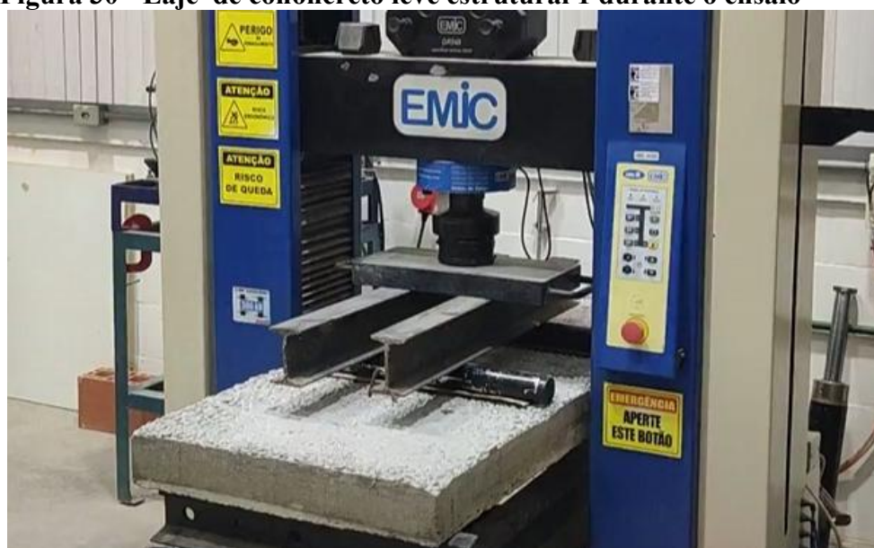
Figura 30 - Laje de concreto leve estrutural 1 durante o ensaio
