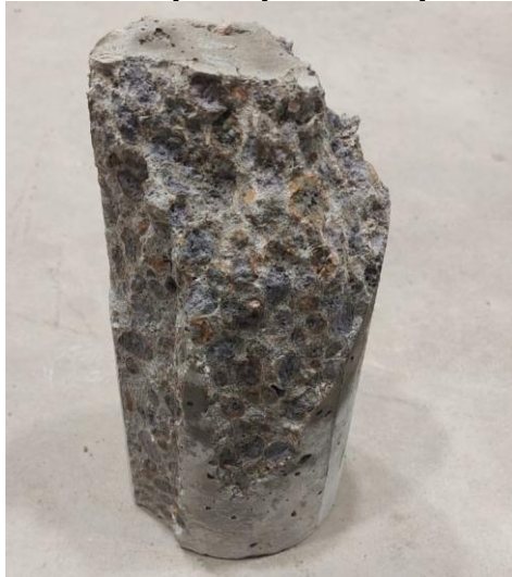
Figura 27 - Corpo de prova rompido
