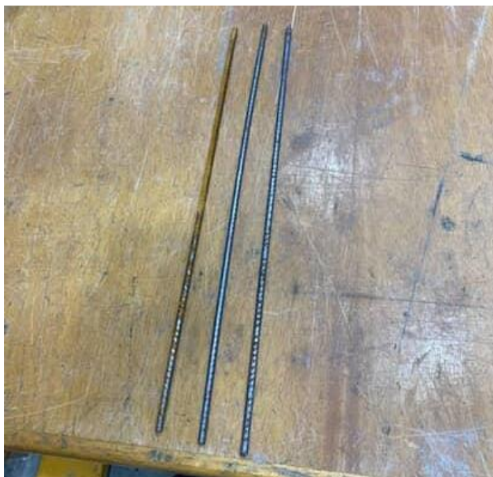
Figura 25 - Barras de aço a serem tracionadas
