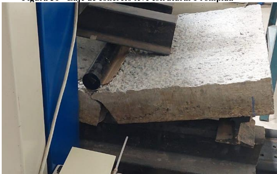
Figura 31 - Laje de concreto leve estrutural 1 rompida
