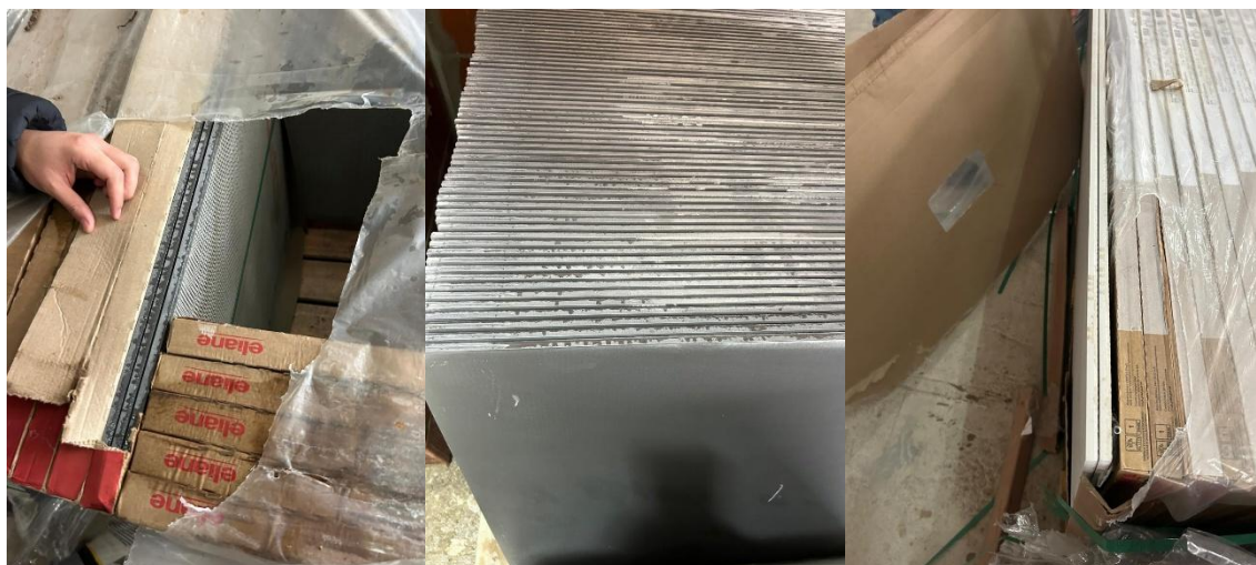
Figura 91 - Peças cerâmicas com defeito de fábrica
