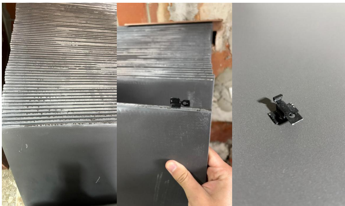
Figura 93 - Ranhuras para encaixe dos dispositivos de fixação metálicos
