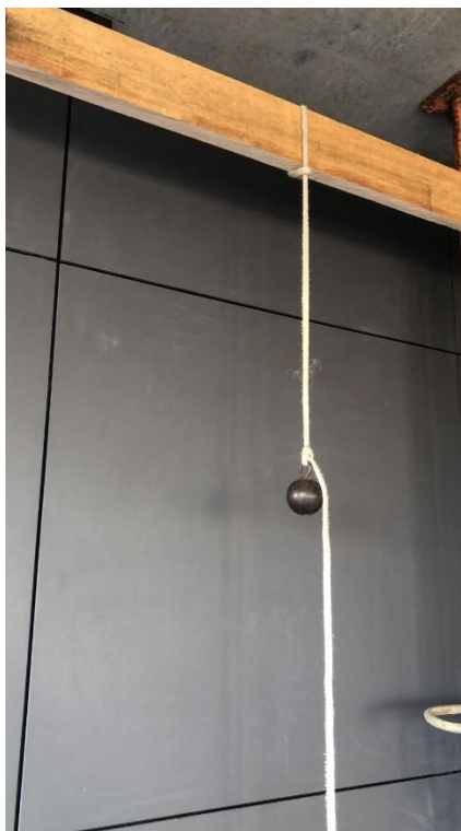
Figura 104 - Estrutura para ensaio de impacto de corpo duro
