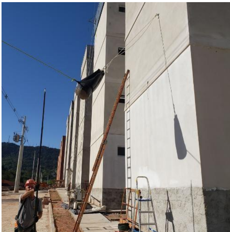
Figura 15 – Ensaio de impacto de corpo mole
