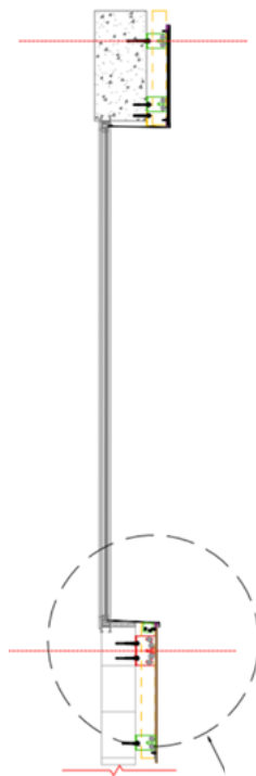
Figura 68 - Vista geral do arremate do peitoril das esquadrias de alumínio
