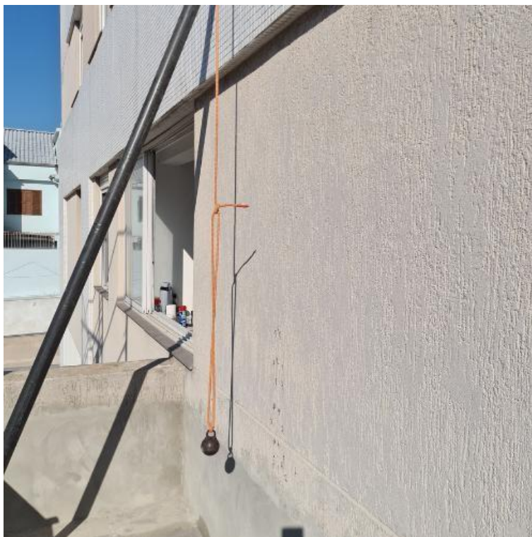
Figura 16 – Ensaio de impacto de corpo duro
