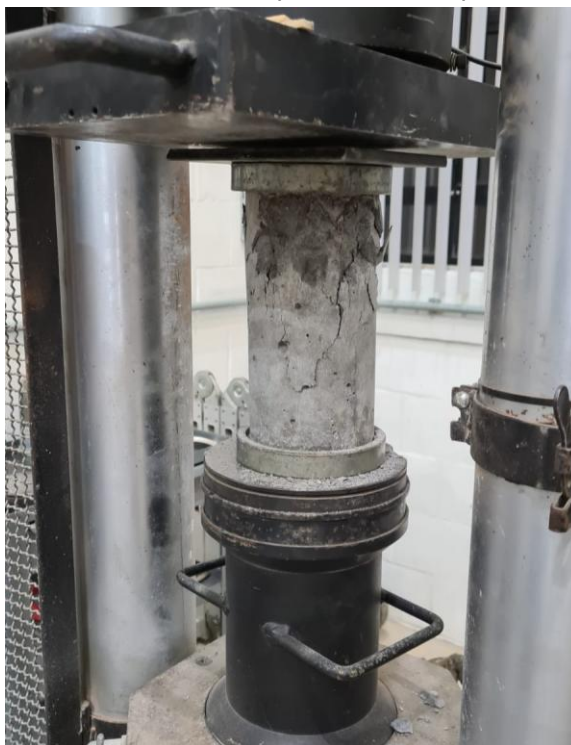
Figura 24 – Ensaio de compressão em corpos cilíndricos
