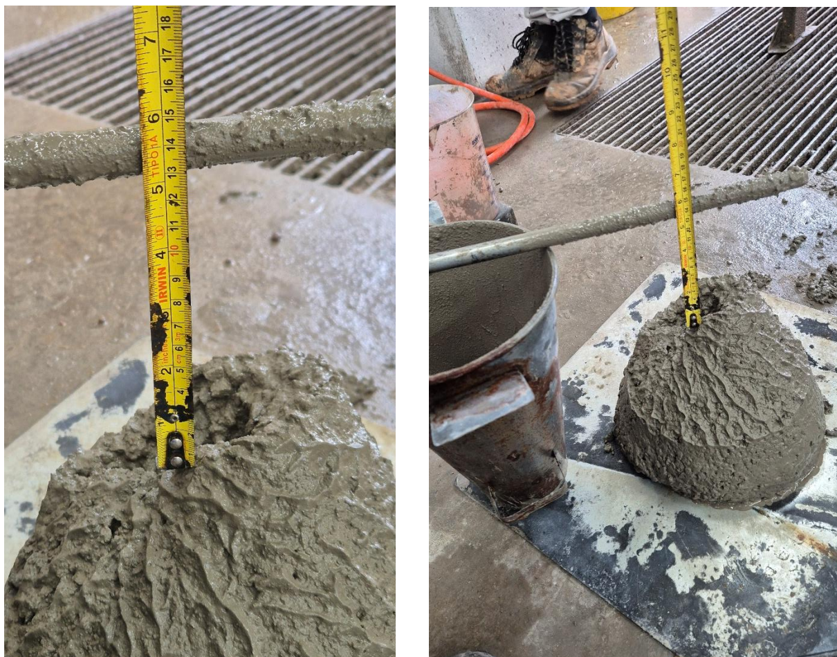
Figuras 21 e 22 – Teste de tronco cone, segunda dosagem
