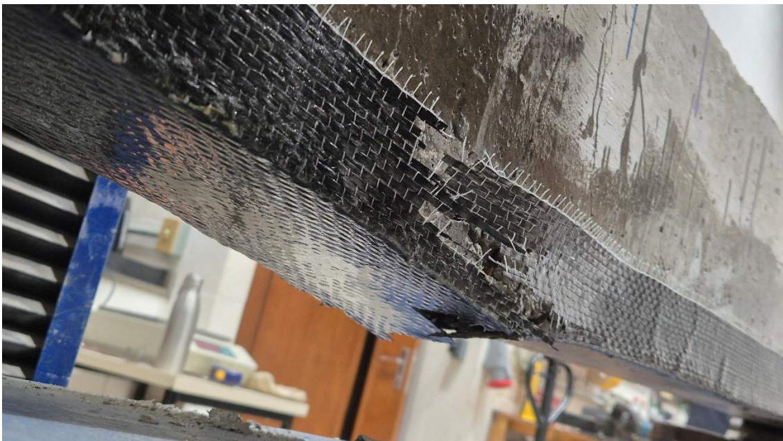
Figura 49 – Viga 3 após ruptura da fibra e do concreto
