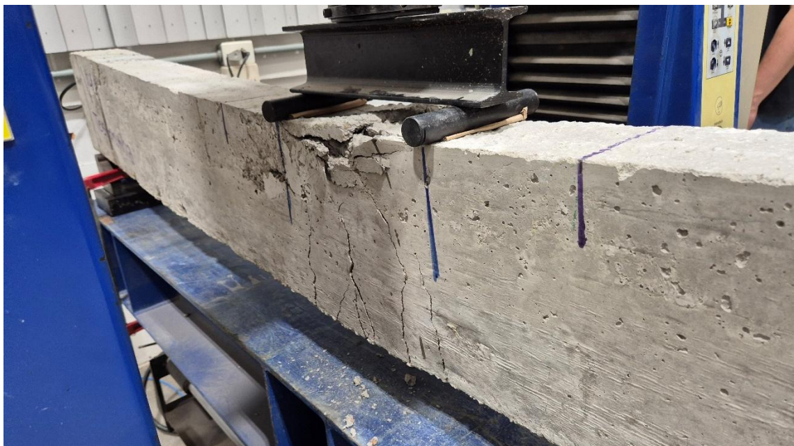
Figura 51 – Viga 4 testemunha após ruptura do concreto
