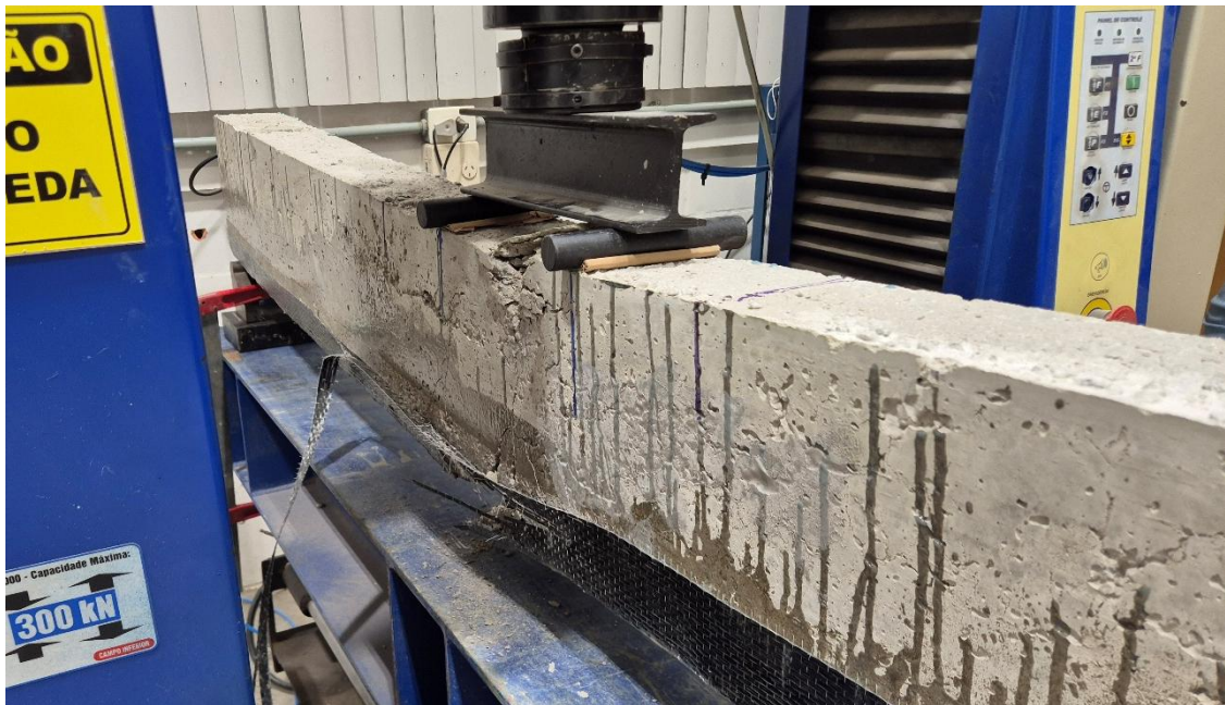
Figura 47 – Viga 2 após ruptura da fibra e do concreto
