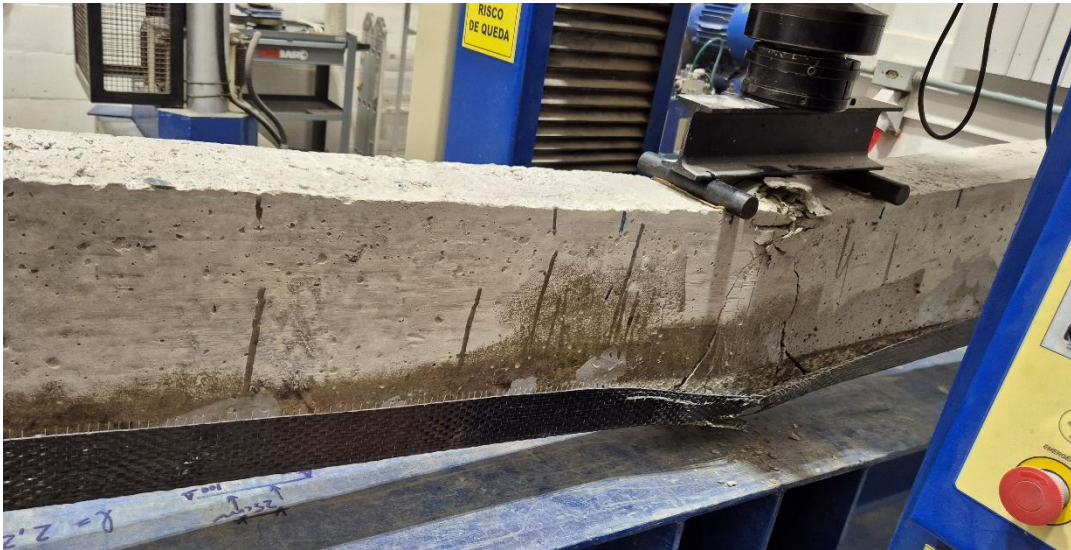
Figura 46 – Viga 1 após ruptura da fibra e do concreto
