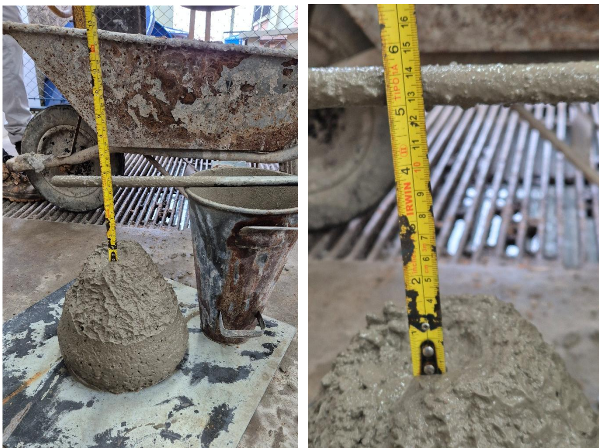
Figura 19 e 20 – Abatimento concreto da primeira dosagem
