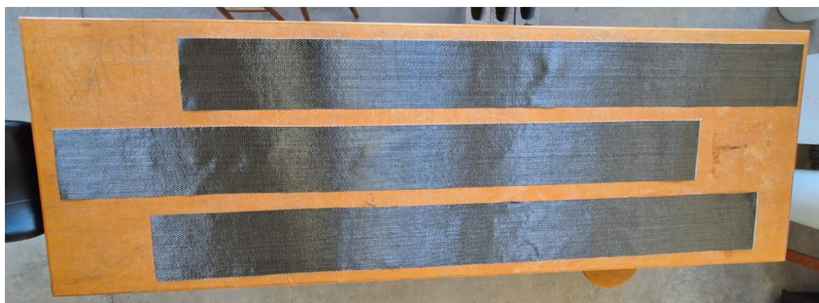
Figura 31 – Corte das fibras de carbono na dimensão de 25cm x 240cm
