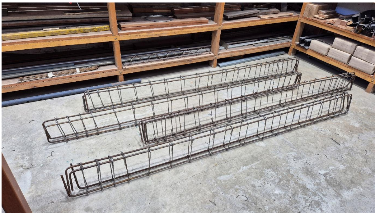
Figura 26 – Armadura das vigas modelo montadas
