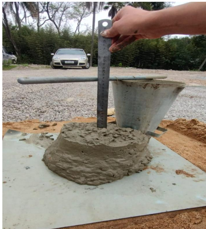
Figura 11 — Determinação da consistência pelo abatimento do tronco de cone (slump test).
