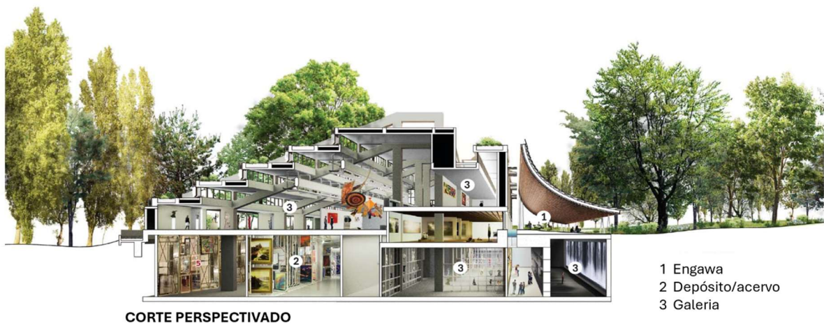
Figura 54: Corte Perspectivado | Fonte: Architectural Record
