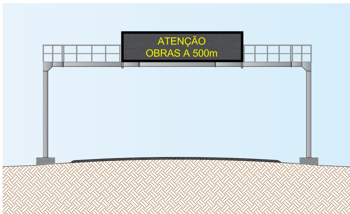
Figura 1 - Pórtico com PMV fixo
