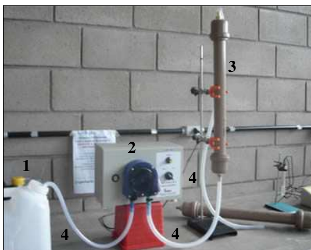
Figura 17 – Ilustração do Sistema de Troca Iônica Laboratório UNISC (1) Bombona com Efluente. (2) Bomba peristáltica. (3) Coluna de Troca Iônica. (4) Mangueiras de silicone.
