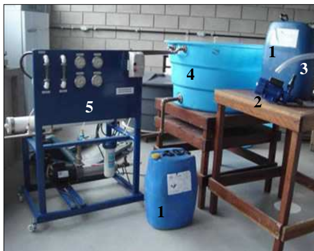
Figura 18 – Ilustração do Sistema de Osmose Reversa Laboratório UNISC (1) Bombonas com Efluente. (2) Motobomba Centrífuga Standard. (3) Mangueira de silicone. (4) Caixa de Contenção. (5) Equipamento de Osmose Reversa.
