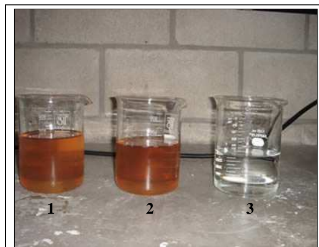
Figura 27 – (1) Ilustração do Efluente Final. (2) Rejeito. (3) Permeado ou Percolado.
