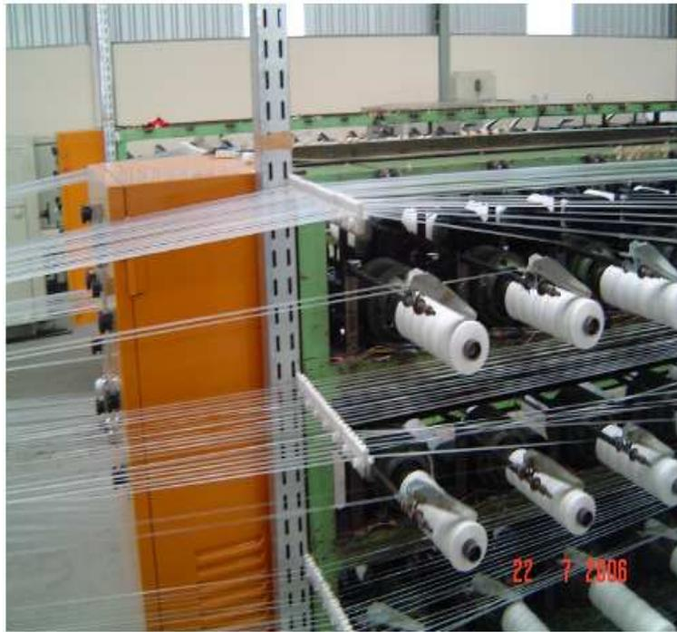
Figura 21: Bobinadeira de fitas
