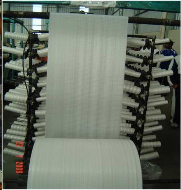
Figura 24: Bobinador de saída do tecido
