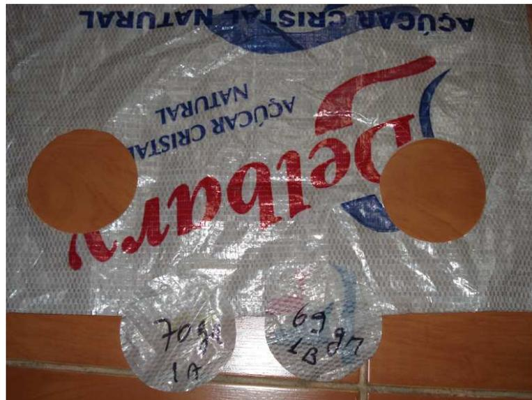
Figura 20: Amostra do teste de gramatura
