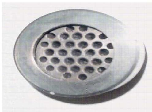
Figura 7: Fotografia de uma placa perfurada.
