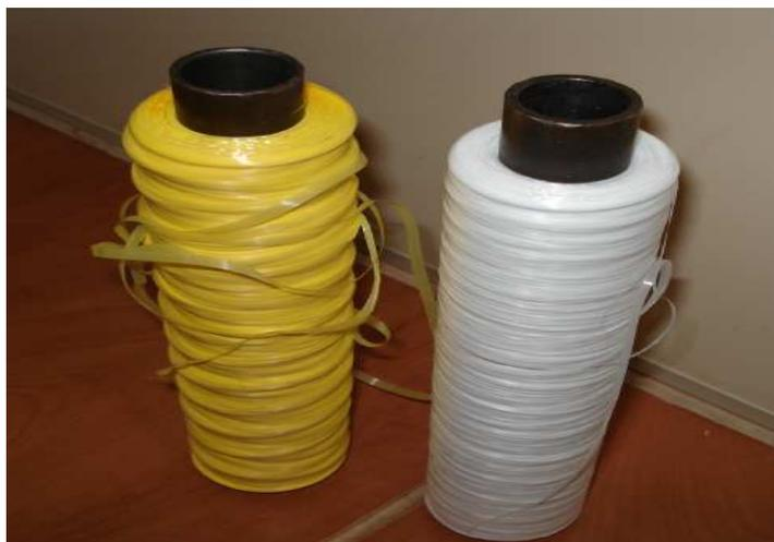
Figura 19: Bobinas de fita de trama e de urdume
