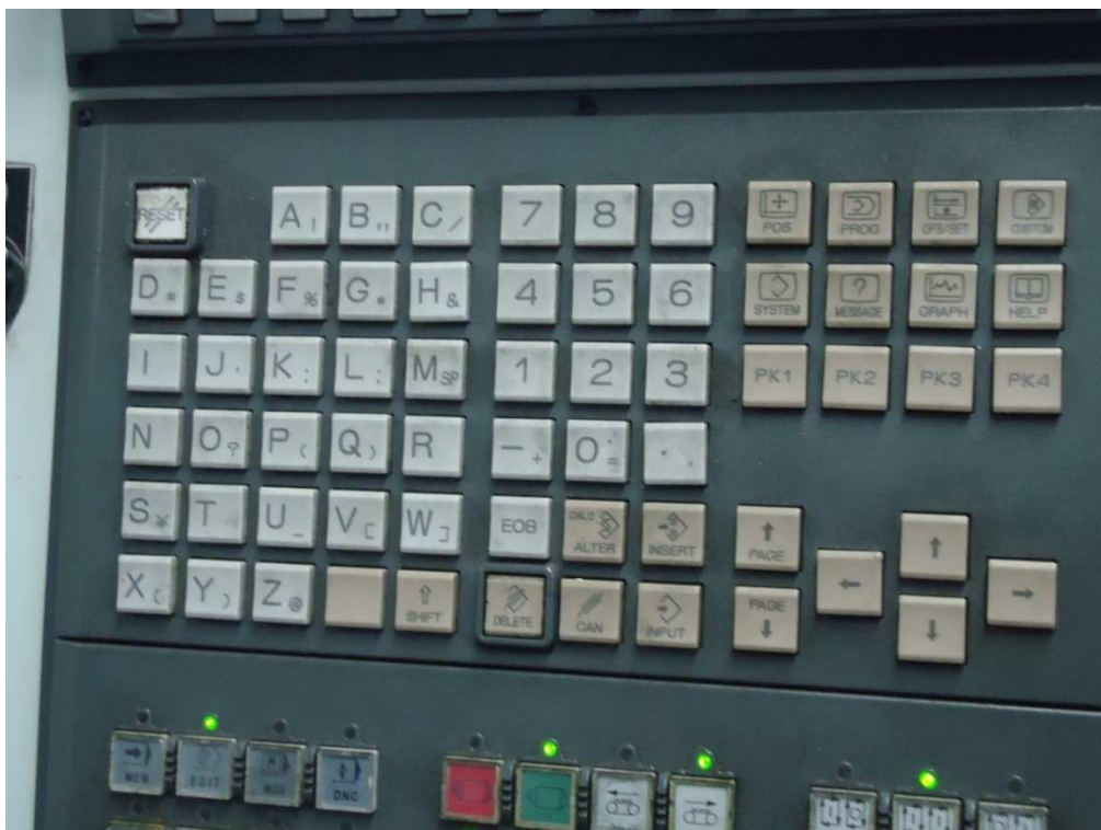
Figura 9 - Painel de torno CNC com diversas teclas de comando em língua inglesa
