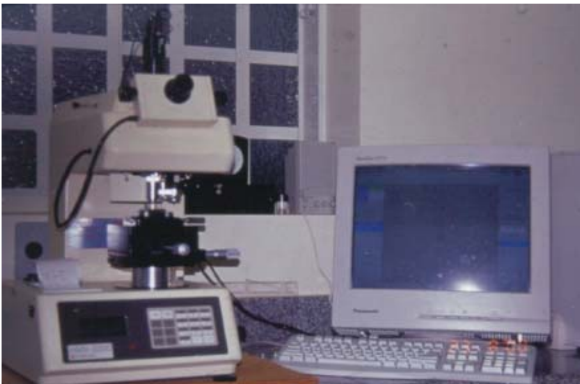
Figura 4 – Microdurômetro acoplado a um software para análise de imagens.
