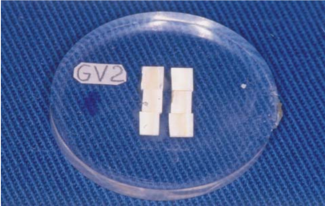
Figura 7 – Corpo de prova em posição lateralizada para a leitura da microdureza em secção longitudinal.
