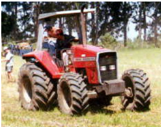
FIGURA Erro! Argumento de opção desconhecido. - Trator de teste equipado com os pneus radiais XM-27 Michelin.
