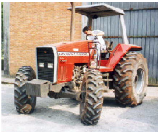
FIGURA Erro! Argumento de opção desconhecido. - Trator de teste equipado com os pneus diagonais Dyna torque II Goodyear.
