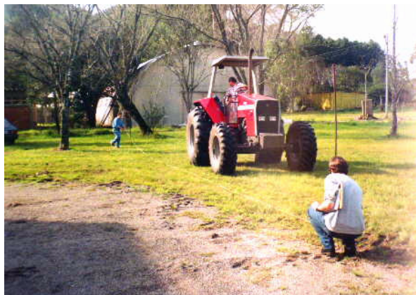
FIGURA Erro! Argumento de opção desconhecido. - Medição da distância percorrida pelos pneus diagonais na superfície de referência para a determinação da relação cinemática do trator de teste.
