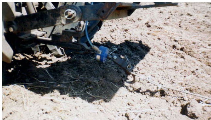
FIGURA Erro! Argumento de opção desconhecido. - Célula de carga e a sua posição nos testes de tração.
