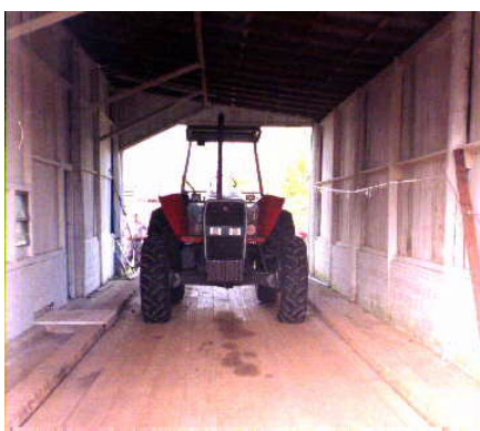
FIGURA Erro! Argumento de opção desconhecido. - Determinação do peso total do trator com pneus diagonais.
