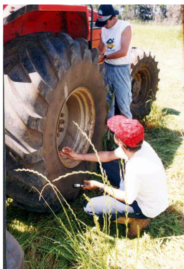
FIGURA Erro! Argumento de opção desconhecido. - Retirada da pressão interna do pneu com o auxílio de chave para válvula.
