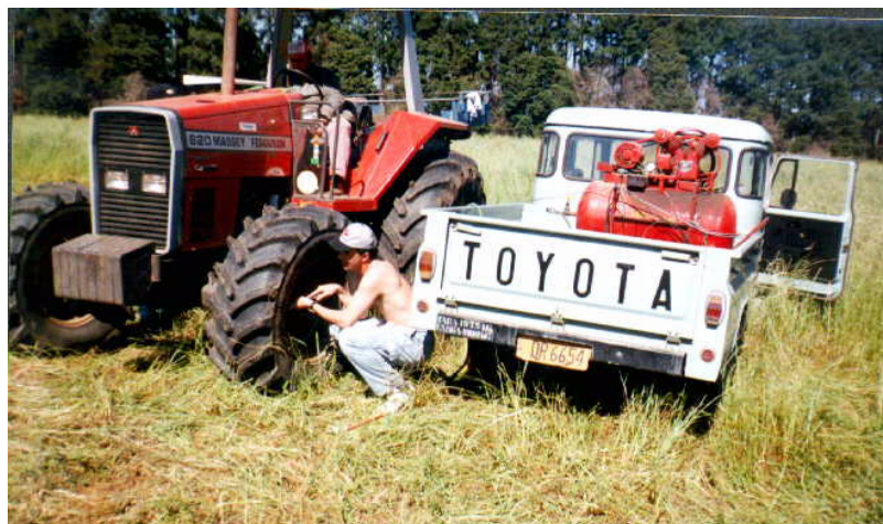
FIGURA Erro! Argumento de opção desconhecido. - Compressor de ar sobre a utilitário, facilitando os trabalhos de variação de pressões internas na área experimental.
