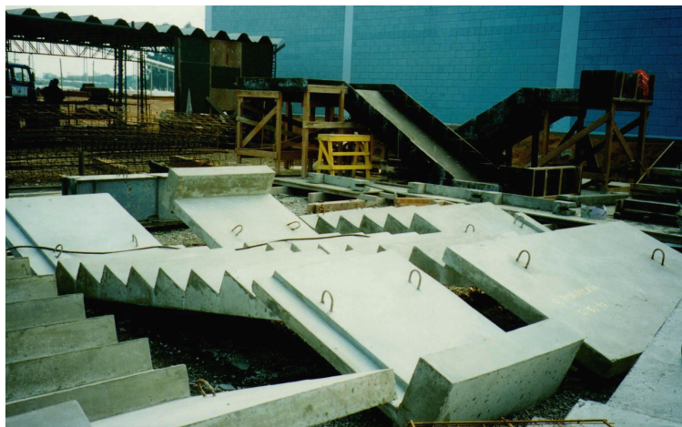
Figura 30 – Escada industrializada, em peça única.
