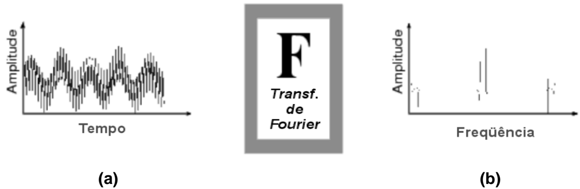
Figura 1 – (a) Gráfico de um sinal – amplitude x tempo, (b) Gráfico de um sinal – amplitude x freqüência (Transformada de Fourier)
