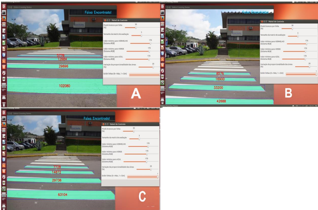
Figura 30: Detecção da FTP posicionando a câmera em diferentes alturas
