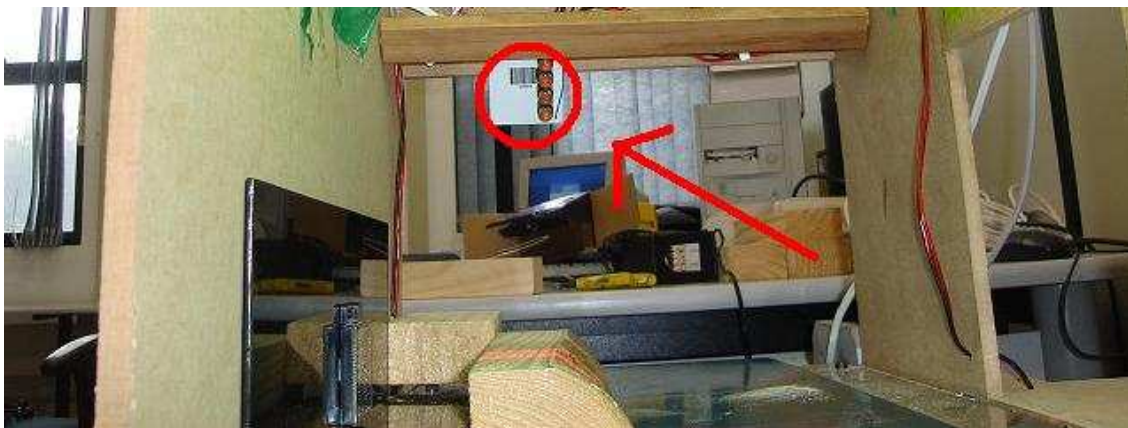
Figura 34: Quatro emissores de linhas lasers em um ângulo de 45°
