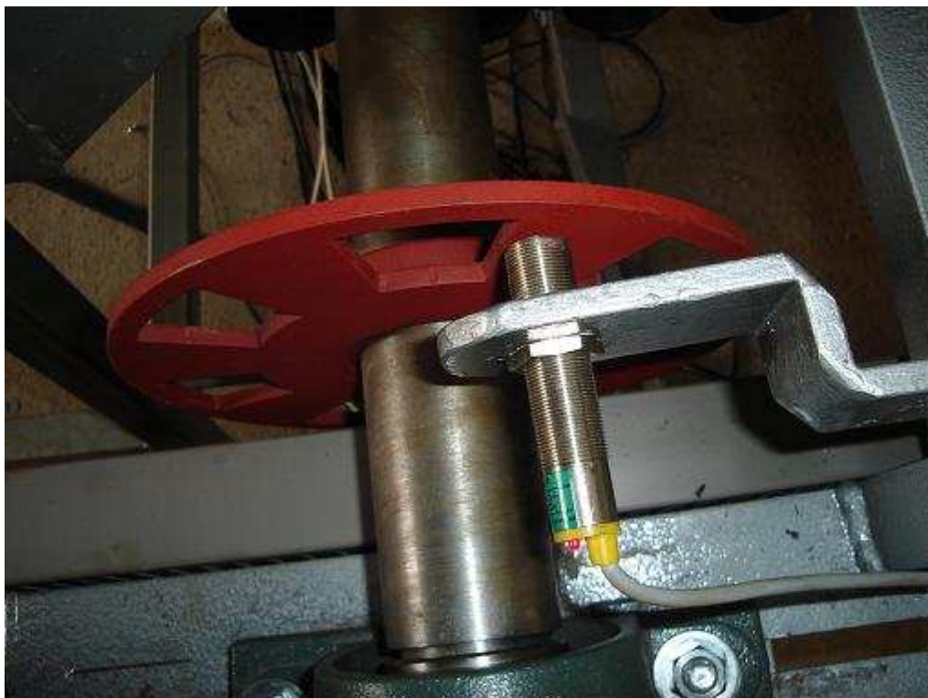
Figura 21: Sensor localizado na engrenagem da esteira.
