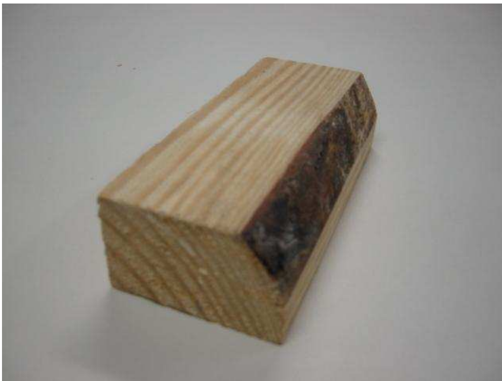
Figura 19: Peça com esmoado no lado direito e com casca.
