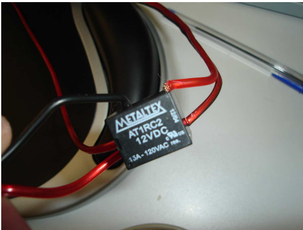
Figura 37: Relé com entrada de em 12 volts
