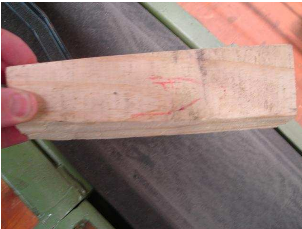
Figura 20: Peça de madeira com esmoado sem casca.
