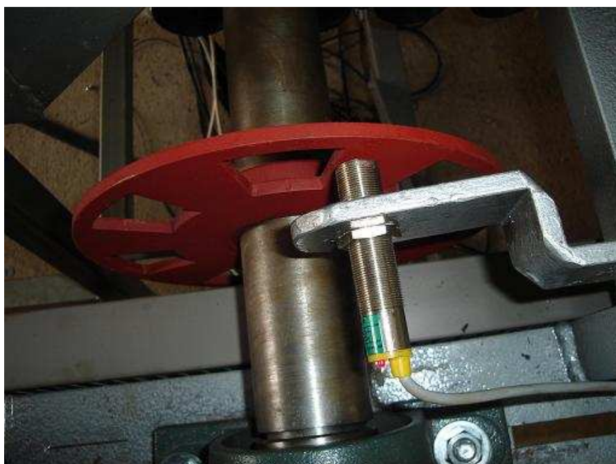
Figura 15: Sensor magnético por efeito Hall localizado em uma engrenagem de uma esteira
