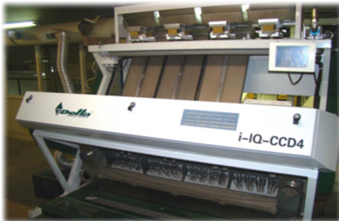
Figura 24 – Foto da máquina selecionadora de grãos de feijão (poroto) na CTJ
