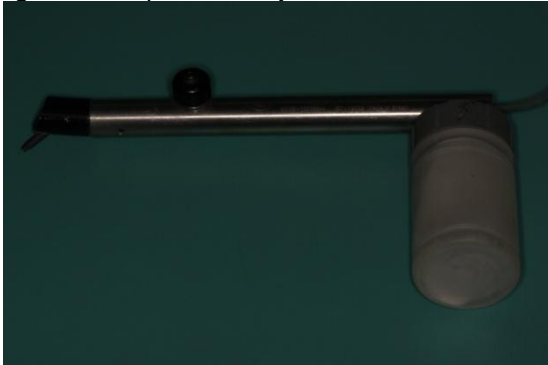
Figura 35 - Aparelho de jato de óxido de alumínio
