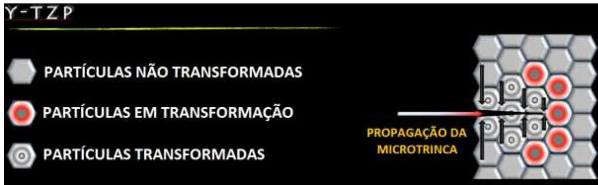
Figura 3 – Esquema representativo da transformação t-m das partículas de zircônia contendo o avanço da trinca ou rachadura
