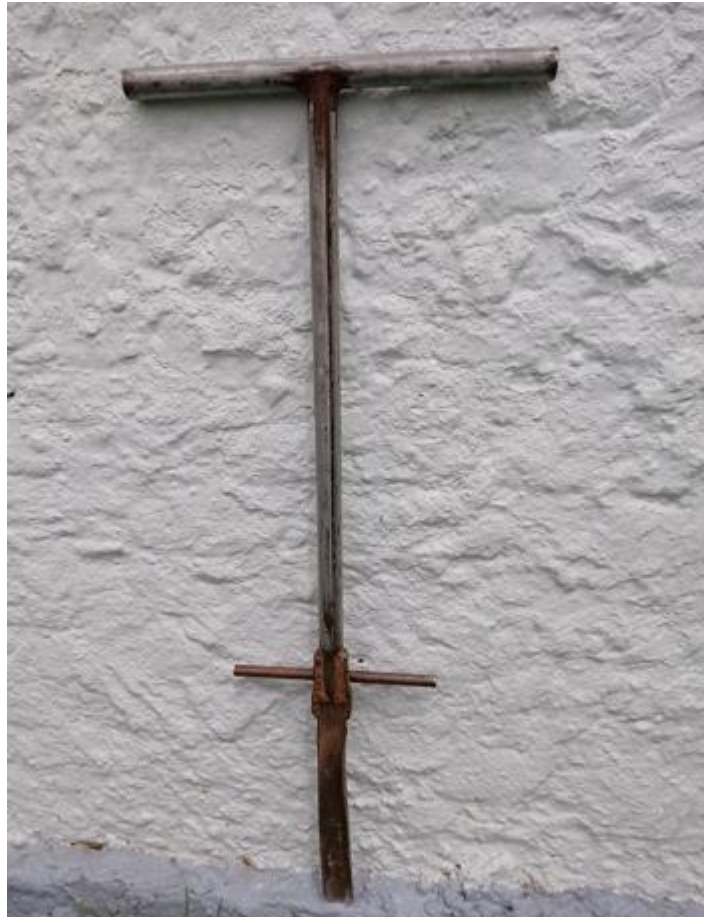
Figura 02: Trado calador utilizado na coleta das amostras.
