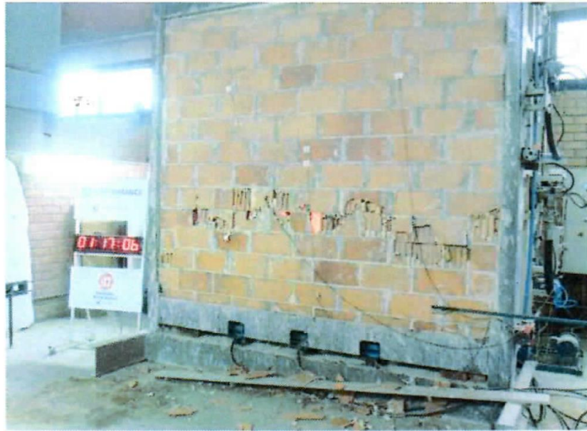
Figura 36 – Face não exposta ao fogo após o término do ensaio
