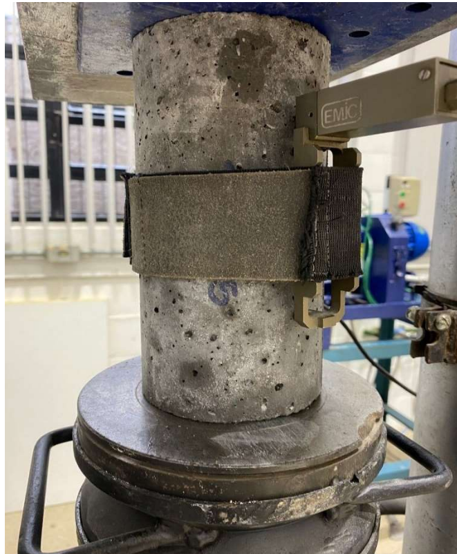
Figura 25 – Ensaio do módulo de elasticidade do CP07 BS20 aos 28 Dias
