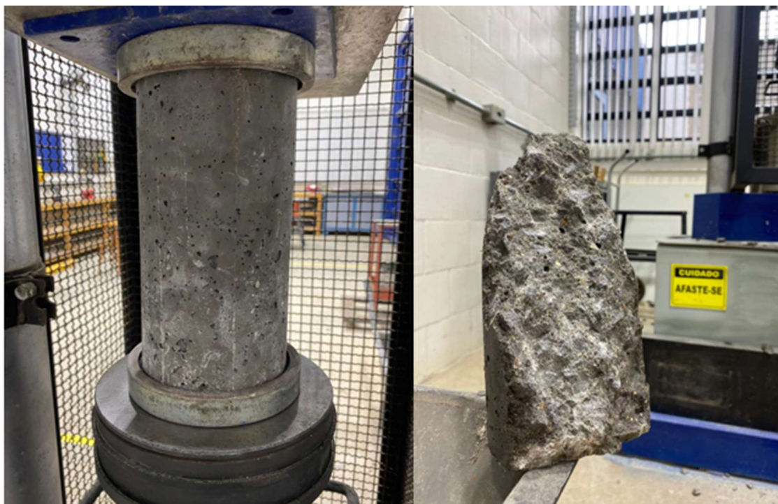
Figura 24 – Antes x Depois CP05 traço BS35 aos 28 Dias
