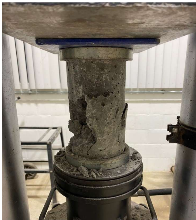
Figura 21 – Ensaio de compressão CP02, traço BS45 em 7 Dias
