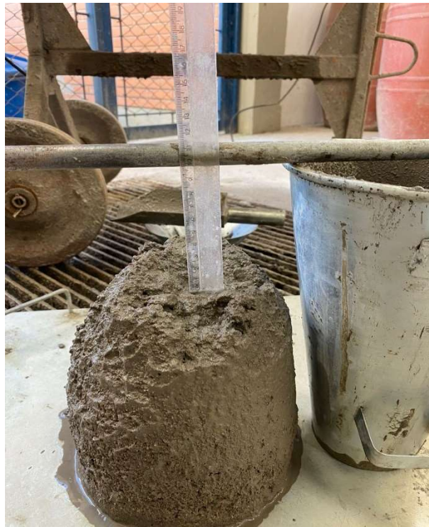
Figura 19 – Abatimento S2 traço BS35
