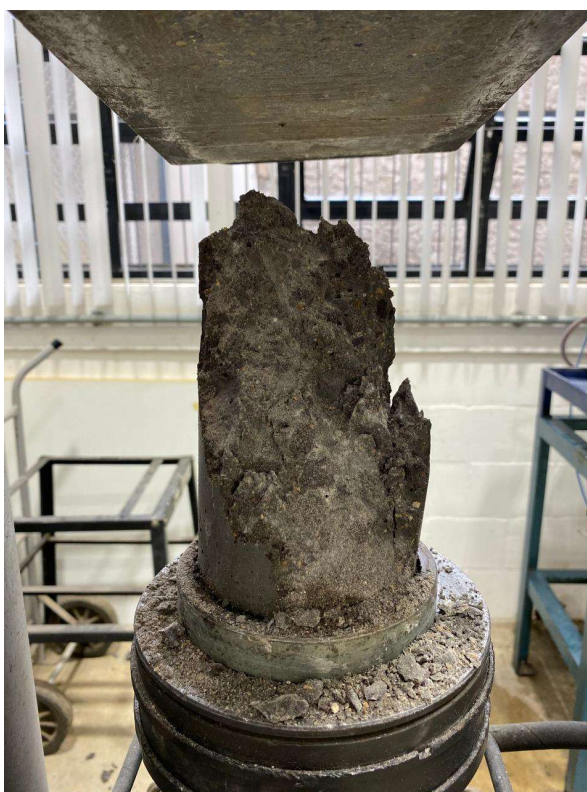
Figura 22 – Ruptura “A” CP04 do traço BS50 aos 28 dias de idade
