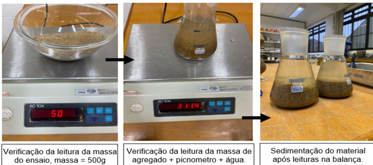
Figura 9 – Ensaio da Determinação da Massa Especifica do Agregado Miúdo
