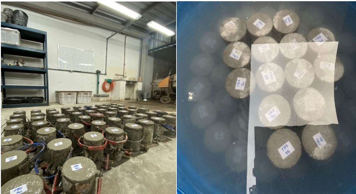
Figura 20 – Cura inicial e cura final em água
