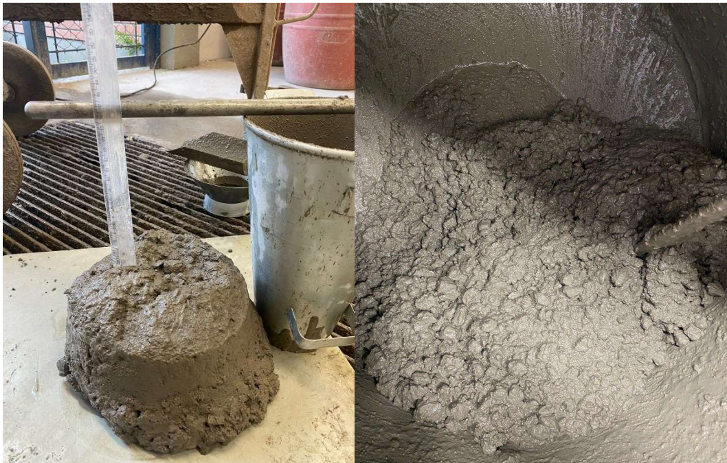
Figura 18 – Traço BS50 pelo ensaio de abatimento e dentro da betoneira
