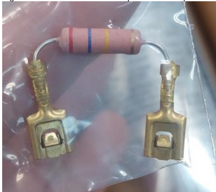
Figura 6 – Resistor associado em paralelo aos capacitores.
