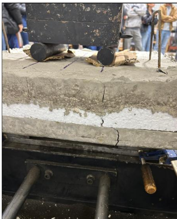
Figura 40 - Ruptura protótipo laje L2
