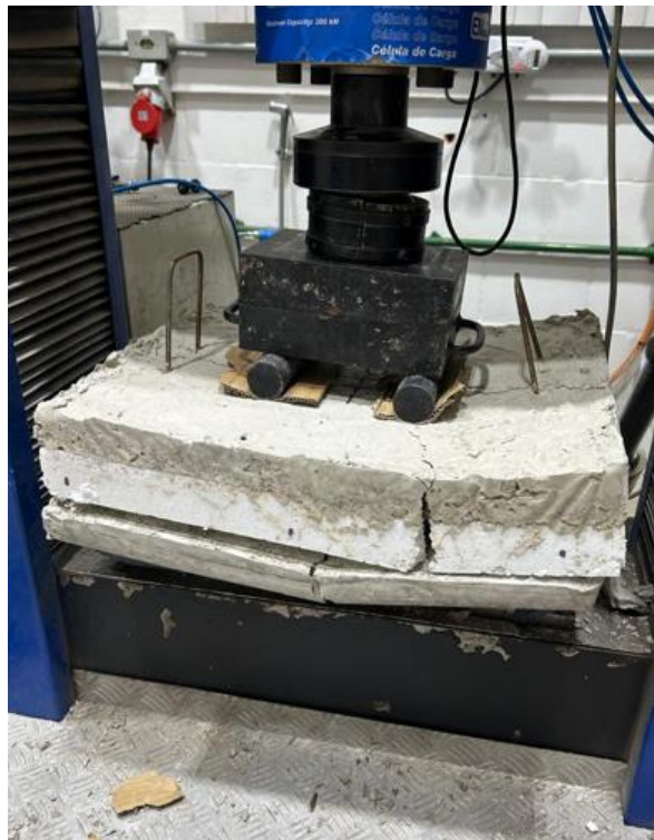
Figura 41 - Ruptura protótipo laje L3
