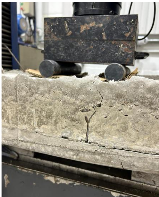
Figura 39 - Ruptura protótipo laje L1
