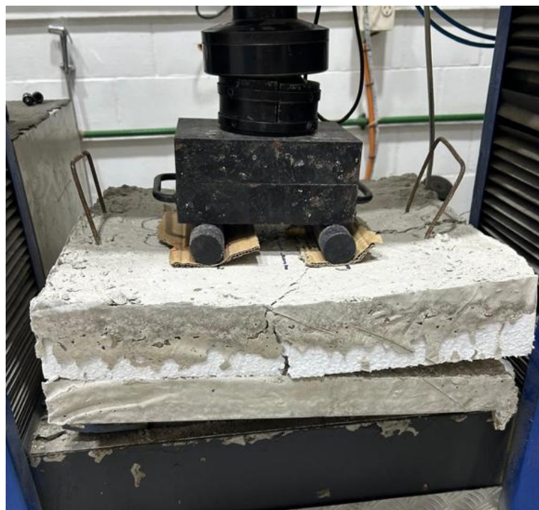
Figura 44 - Ruptura protótipo laje LM3
