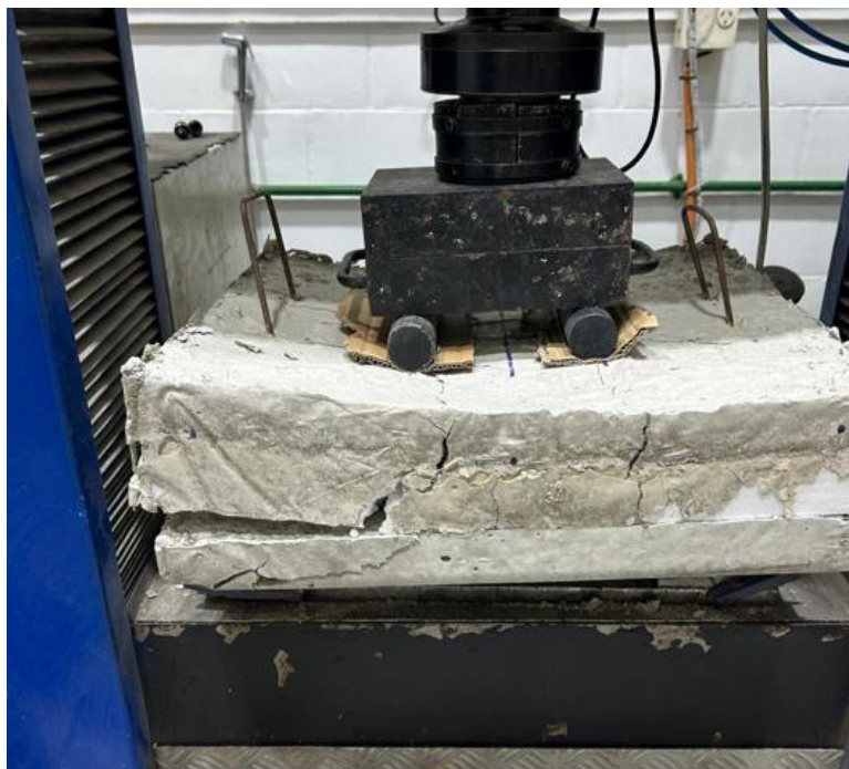
Figura 43 - Ruptura protótipo laje LM2
