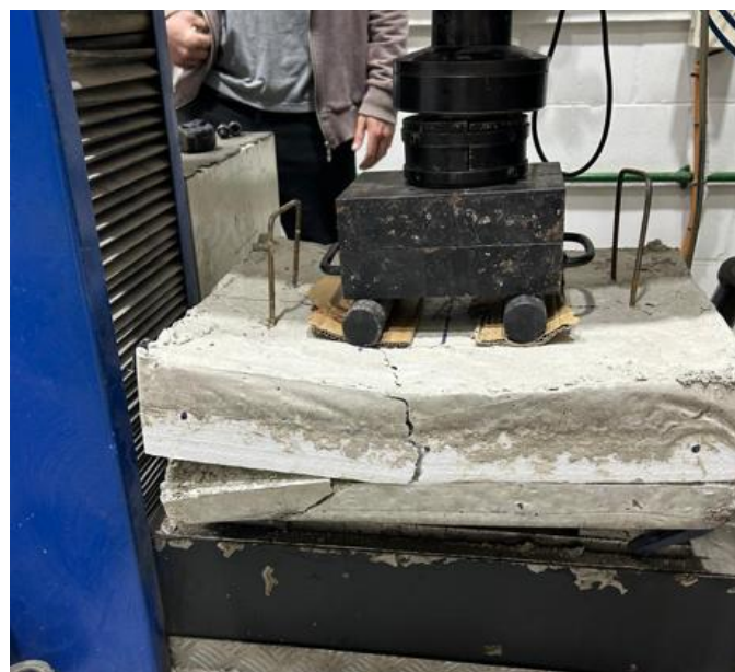
Figura 42 - Ruptura protótipo laje LM1
