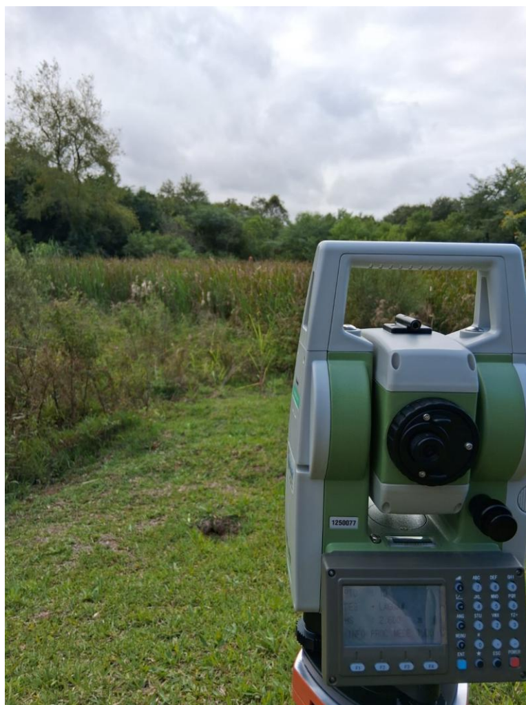
Figura 8 - Equipamento de topografia (Estação Total) posicionado na área de estudo para o mapeamento planialtimétrico das cavas inoperantes.
